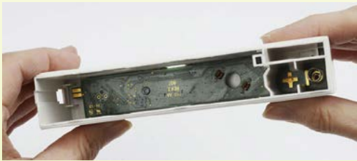
Abb. 41: Plus- und Minuspol der Batterien
