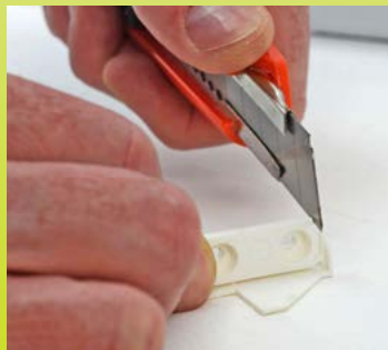
Abb. 7: Montagehilfe 'Segel' (D1) der Fensterrahmen-Halterung (D) abschneiden
